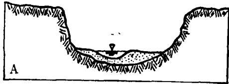
图5 流域系统(侵蚀基准面)出口上游1.5米处的试验河床横断面表明河床侵蚀基准面下降的反应。 A. 基准面下降以前新塑造的河谷和冲积物。在冲积物上流动的低宽深比的河床。
