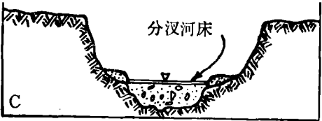
C. 随上游来沙量增加, 沉积了内选冲积物, 这种高宽深比河床为分汊和不稳定河床。
